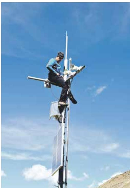
Zusätzlich zum Laserscanning wird der Bliggferner auch noch mit Webcams überwacht.
