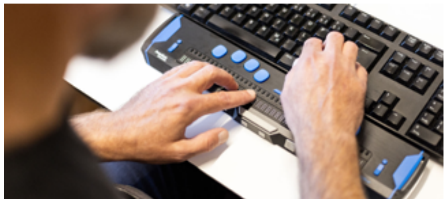
Die Braillezeile ist ein taktiles Ausgabegerät. Es ermöglicht blinden und sehbehinderten Menschen, Informationen zu lesen. Dabei kann es sich um Texte, Bilder, Symbole oder Grafiken handeln.
